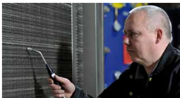
Detecção de vazamentos
